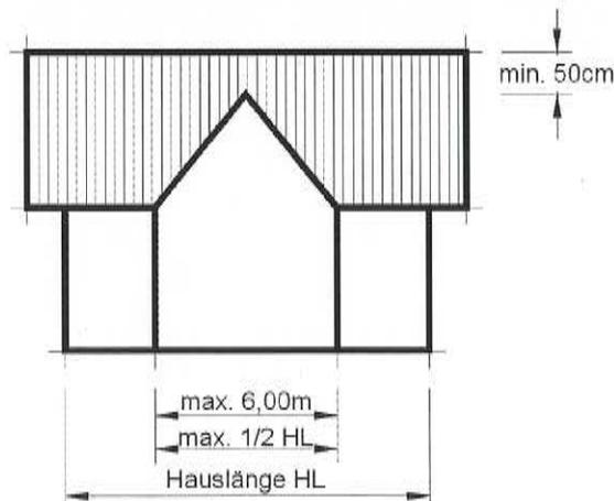
Die Gesamtlänge aller Dachaufbauten, Dacheinschnitte, Querhäuser und Zwerchhäuser je Dachseite darf zwei Drittel der Hauslänge nicht überschreiten. Zur Giebelwand, zu benachbarten Gauben, Quer- oder Zwerchhäusern, zu Dacheinschnitten und Kehlen muss mit Dachaufbauten, Dacheinschnitten, Querhäusern und Zwerchhäusern ein Abstand von mindestens 1,50 m eingehalten werden.
