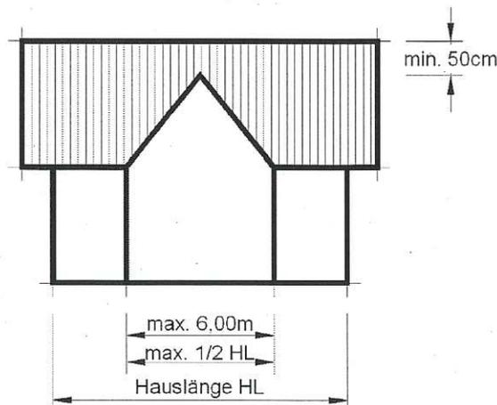
Die Gesamtlänge aller Dachaufbauten, Dacheinschnitten, Querhäuser und Zwerchhäuser je Dachseite darf zwei Drittel der Hauslänge nicht überschreiten. Zur Giebelwand, zu benachbarten Gauben, Quer- oder Zwerchhäusern, zu Dacheinschnitten und Kehlen muss mit Dachaufbauten, Dacheinschnitten, Querhäusern und Zwerchhäusern ein Abstand von mindestens 1,50 m eingehalten werden.
